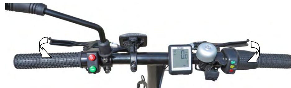
Handbremshebel für Hinterradbremse
